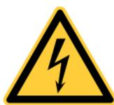
Le **symbole de l'éclair** avec une flèche dans un triangle équilatéral signale à l'utilisateur la présence d'une "tension dangereuse" non isolée à l'intérieur du produit qui pourrait être d'une importance suffisante pour constituer un risque de décharge électrique pour les personnes.
